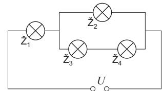
Napetost na žarnici  $\check{Z}_1$  je  $1,50 \text{ V}$ , tok skozi žarnico  $\check{Z}_2$  je  $62,0 \text{ mA}$ , napetost na žarnici  $\check{Z}_3$  je  $0,30 \text{ V}$ .
