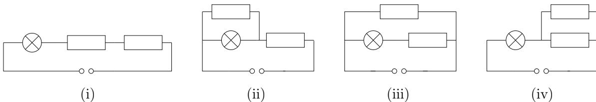
V vezju (i) je napetost na žarnici tretjina  $U_0$ , torej  $4 \text{ V}$ , v vezju (ii) je nadomestni upor vzporedno vezane žarnice in upornika  $4 \Omega$  in zato napetost na žarnici prav tako tretjina  $U_0$ ,  $4 \text{ V}$ , v vezju (iii) zgornji upornik ne vpliva na napetost na žarnici in je ta enaka polovici  $U_0$ ,  $6 \text{ V}$ , v vezju (iv) pa je nadomestni upor upornikov  $4 \Omega$  in napetost na žarnici dve tretjini  $U_0$ ,  $8 \text{ V}$ .
